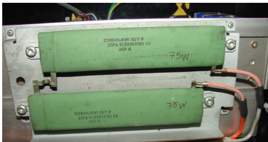
Figura 2.26: Resistencias de potencia del circuito de estabilización del voltaje de la barra DC.
