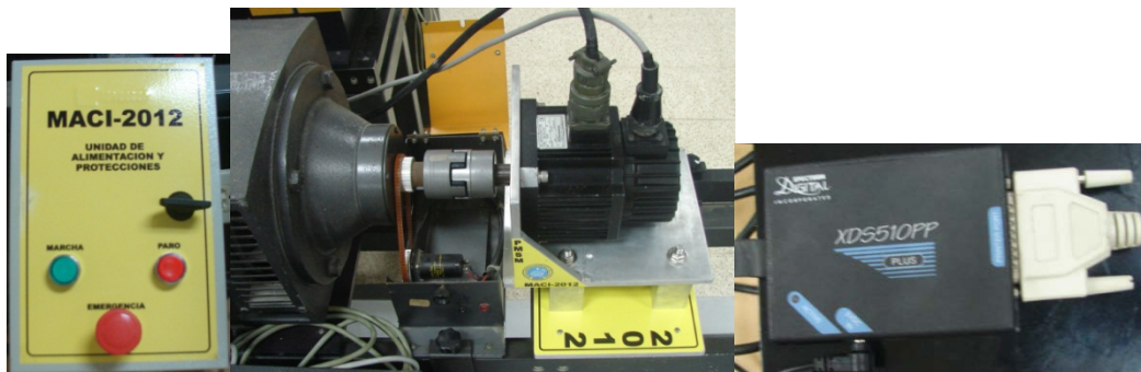
Figura 3.10: Equipo MACI-2012 con la bancada de motores TERCO.
