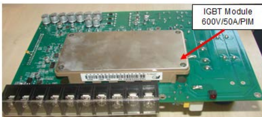
Figura 2.13: Vista superior del módulo de potencia para el accionamiento de servomotores YPV-200.
