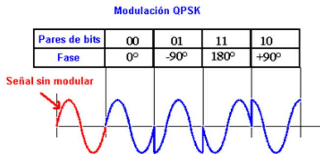
Figura 2.12. Cuadro de fases de la Modulación QPSK [5]
