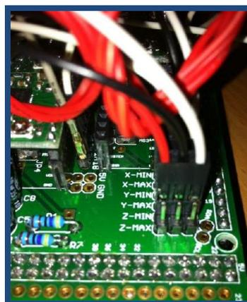
**Figura 4.14** Conexión de los finales de carrera mecánicos.
