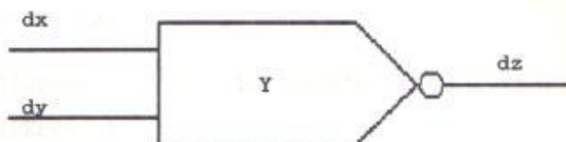
FIG. 1.6 INTEGRADOR DIGITAL CON SALIDA NEGATIVA
