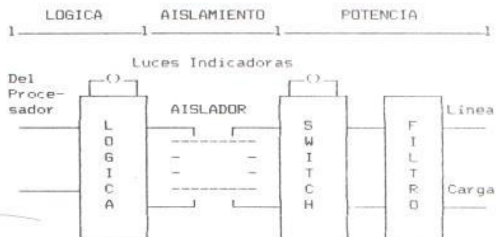
Fig. 2.4.1.a Diagrama de Bloque de una Salida AC
