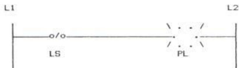
Fig. 3.3.b Esquema de un Circuito con Lógica de Rélés
