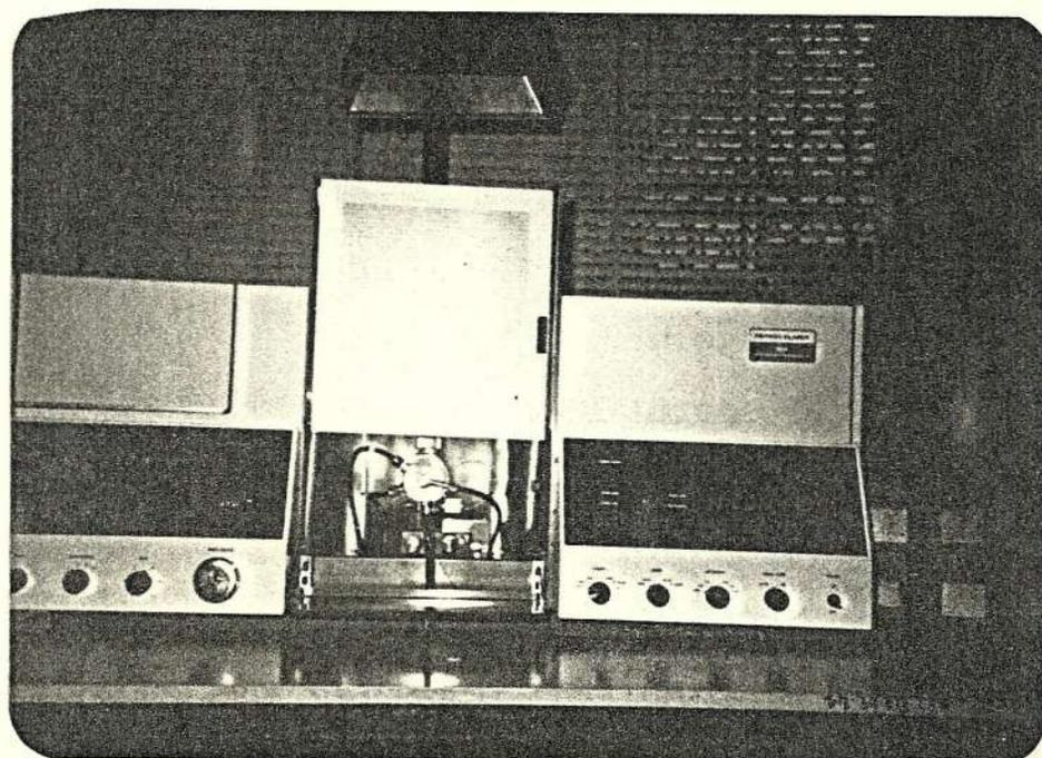
FIG 11 Espectroscopio de absorción
