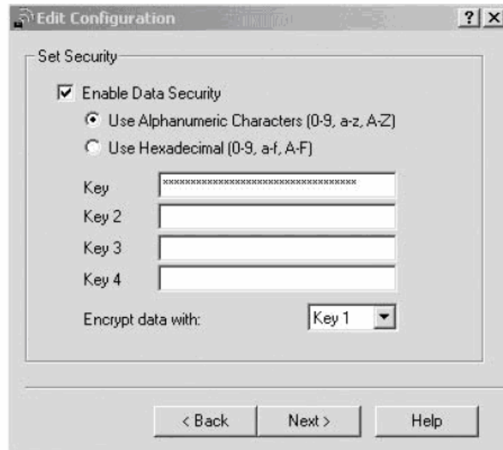
Fig. 1.82 Configuración de encriptación WEP en modo Shared Key
