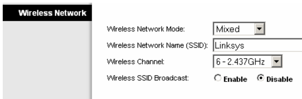
Fig. 2.44 Deshabilitación del broadcast de SSID en Router Linksys.
