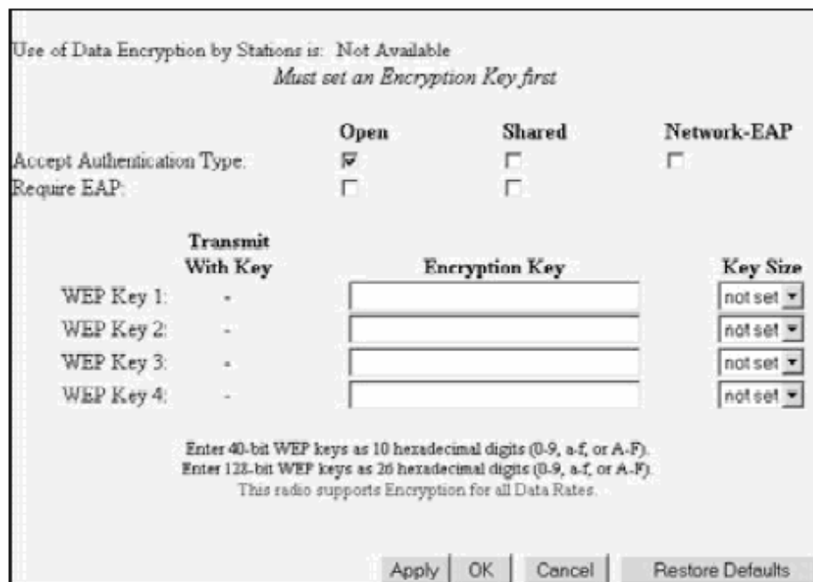
Fig. 1.83 Configuración de encriptación WEP en Open System.
