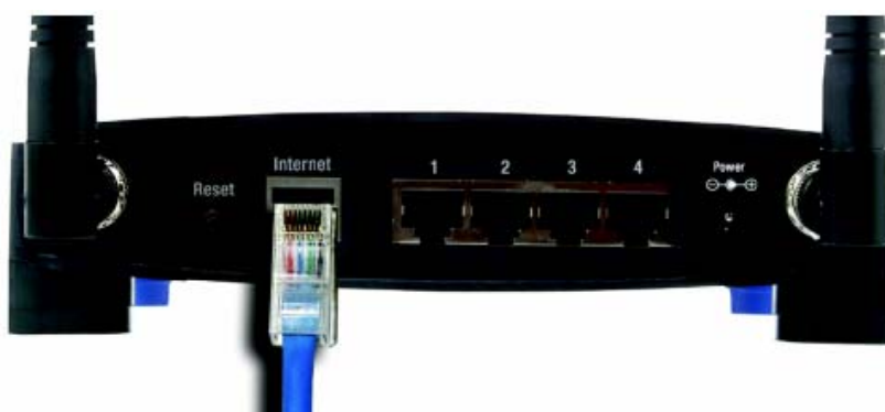
Fig. 2.11 Conexión al puerto WAN del Router Linksys para Internet.
