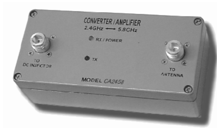
Fig. 1.39 Convertidor de frecuencia
