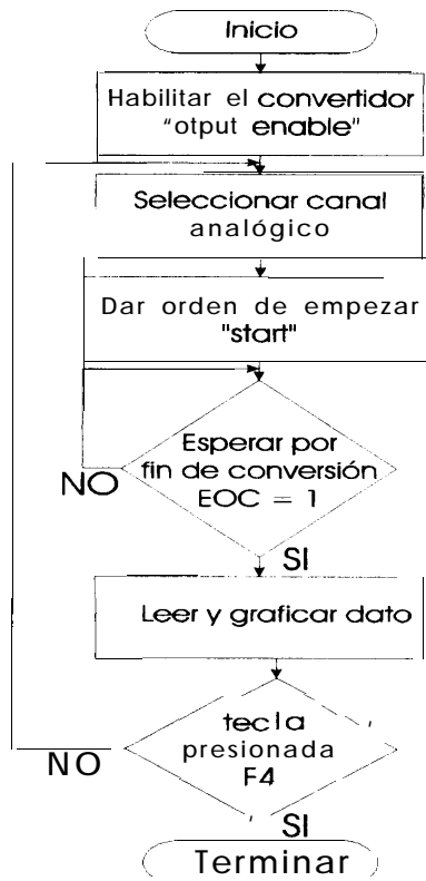
FIGURA 3.10 DIAGRAMA DE FLUJO PARA LA UTILIZACIÓN DEL CONVERTIDOR ADC0808
