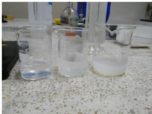
Figura 3.14 Muestras de aguas con \text{AgNO}_3 0.1 N antes y después del tratamiento
