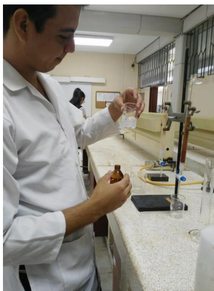
Figura 3.12 Comprobación de la remoción de iones con ( \text{AgNO}_3 ) 0.1 N
