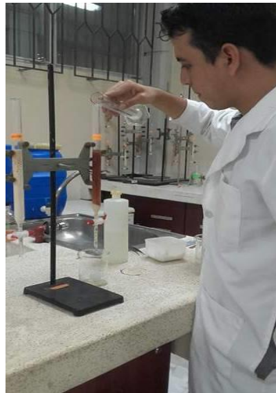
Figura 3.11 Tratamiento del agua con el sistema de intercambio iónico
