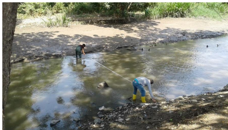
Figura 3.3 Método para medir ancho, profundidad y velocidad del Estero Sabanilla
