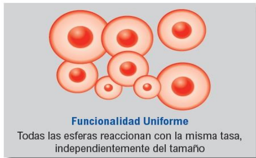
Fig. 1 – Profundidad uniforme de funcionalidad
