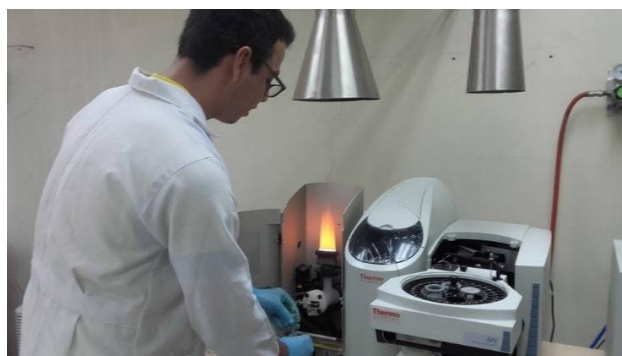
Figura 3.7 Análisis de sodio de las muestras realizado en el espectrofotómetro mediante el método de la llama.
