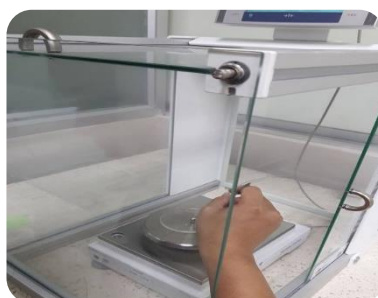
Figura 2.12. Balanza analítica Mettler Toledo para TGA
