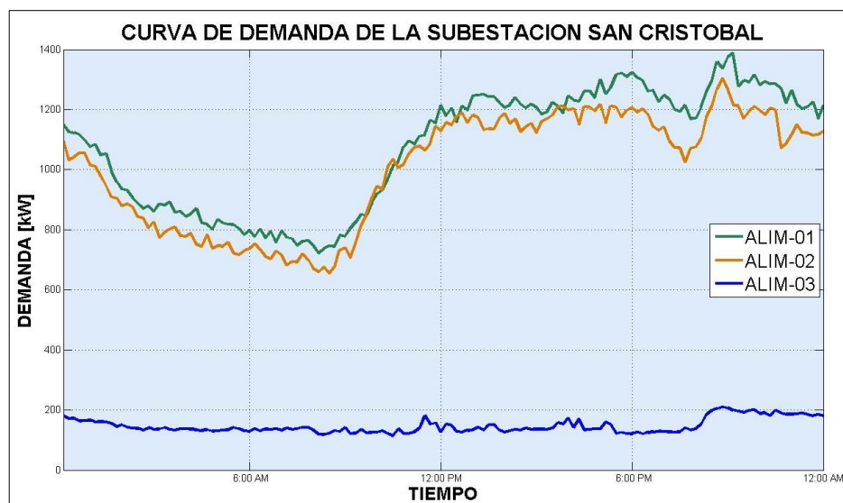
Figura 2.2: Curva de Demanda de los Alimentadores en la Subestación. [9]
