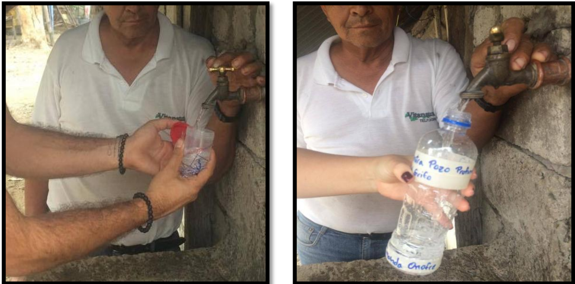
Figura 3.1.2. Toma de muestras de agua. (Izquierda, muestras para análisis microbiológicos. Derecha, muestras para análisis físico-químicos).
