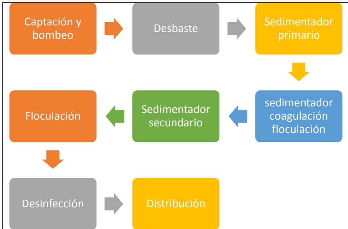
Figura 2.4.1. Planta de tratamiento convencional
