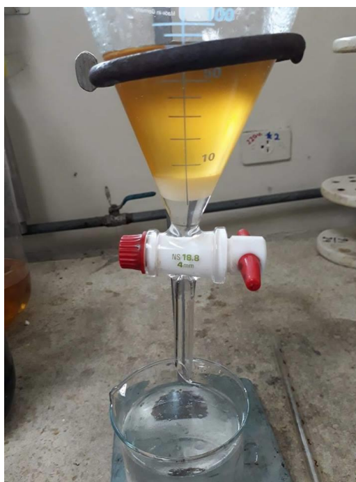
Figura 2.9. Separación de fases aceite de fusel- salmuera
