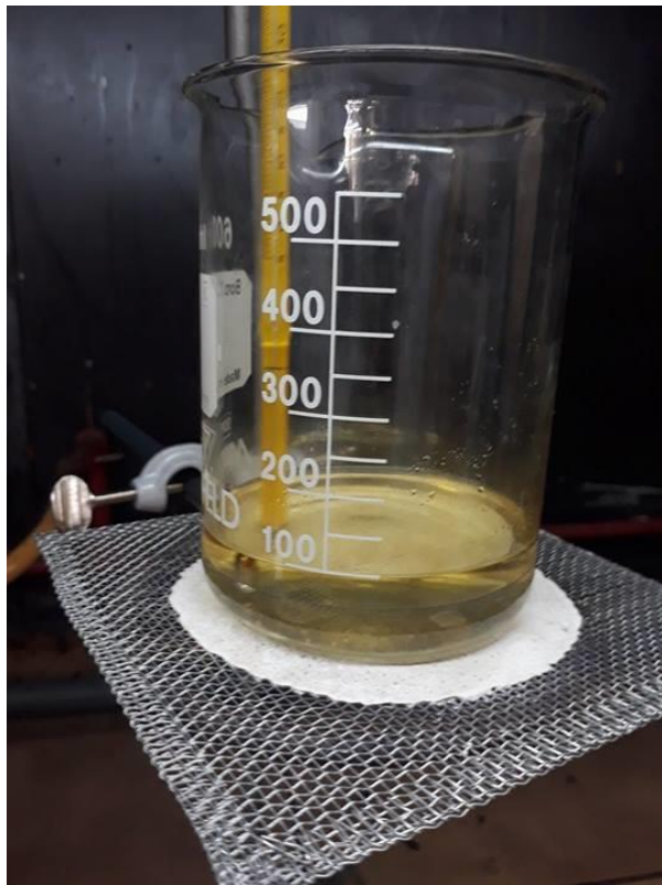
K3. Extracción líquido-líquido a 40 °C
