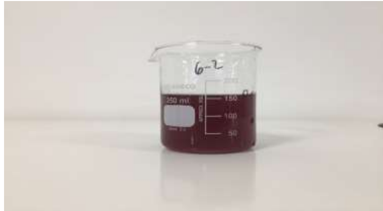
Figura 2.15. Coloración de la muestra después de agregar 3mM \text{FeSO}_4 y 100mM \text{H}_2\text{O}_2
