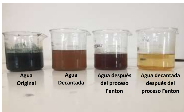
Figura 3.7. Variación de coloración del efluente en cada una de las etapas del tratamiento. (Agua negra residual, agua decantada pH 3, agua del proceso Fenton, agua filtrada pH 7)
