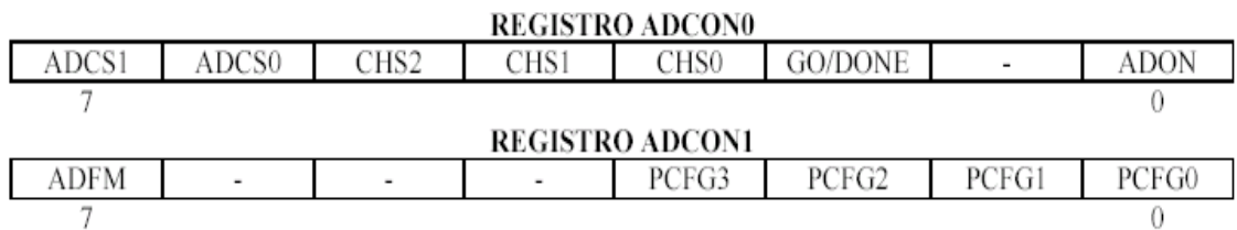
FIGURA 7.11. REGISTROS DE TRABAJO ADCON0 Y ADCON1
