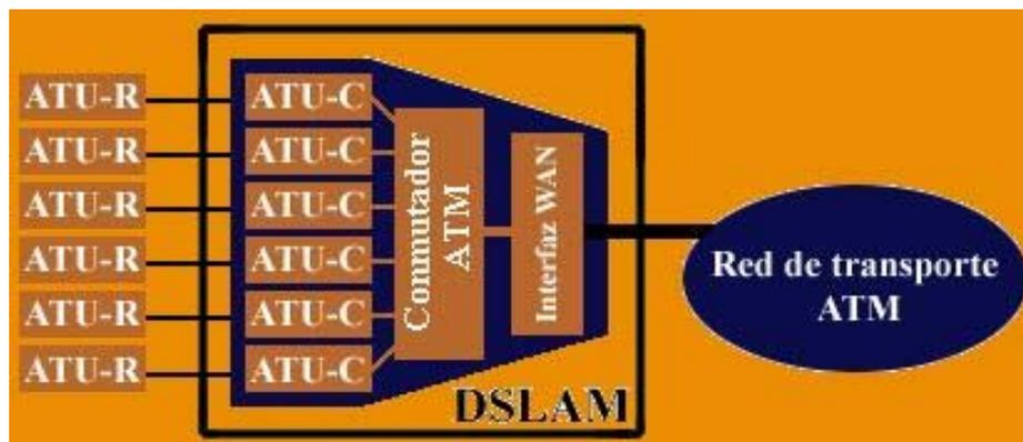
**Esquema Interno del DSLAM**
