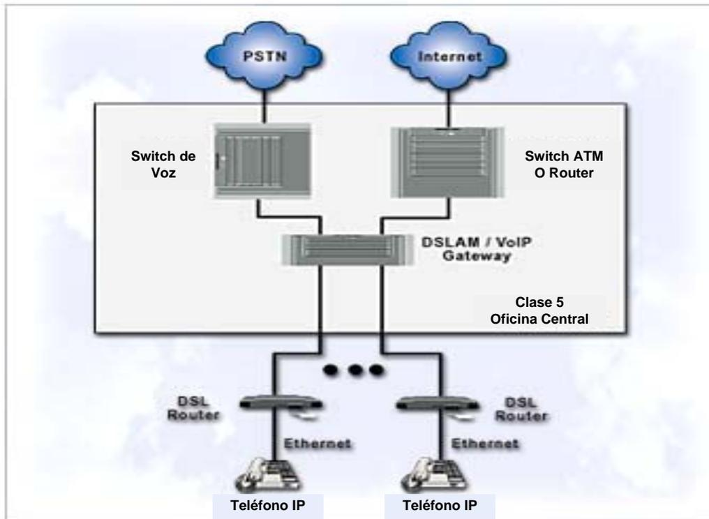
**Esquema del DSLAM con Voz sobre IP**
