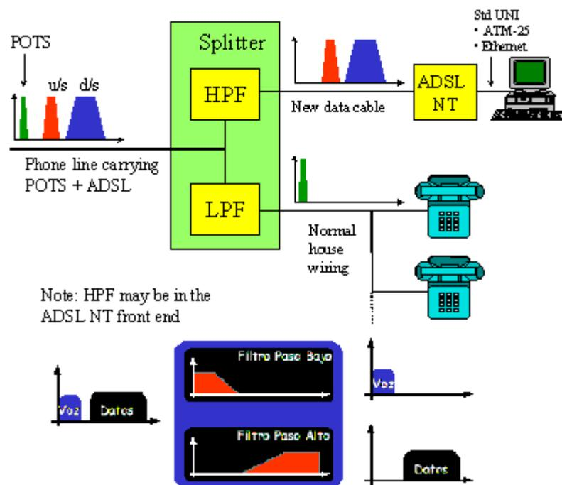
**Separación Voz y Datos. Funcionamiento del Splitter**
