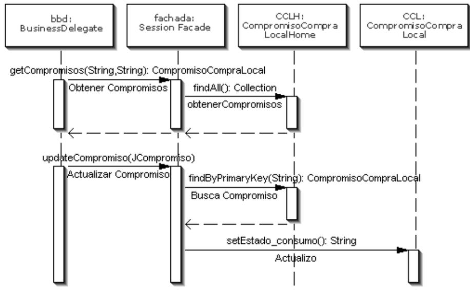
**Figura 26.**- Implementación del patrón de diseño Fachada de Sesión en la aplicación del servidor
