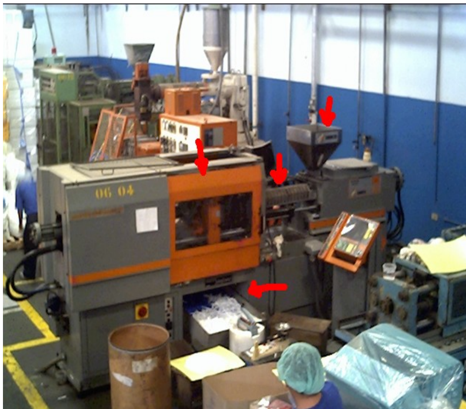
Figura 9.1.1 Puntos de riesgo en la inyectora
