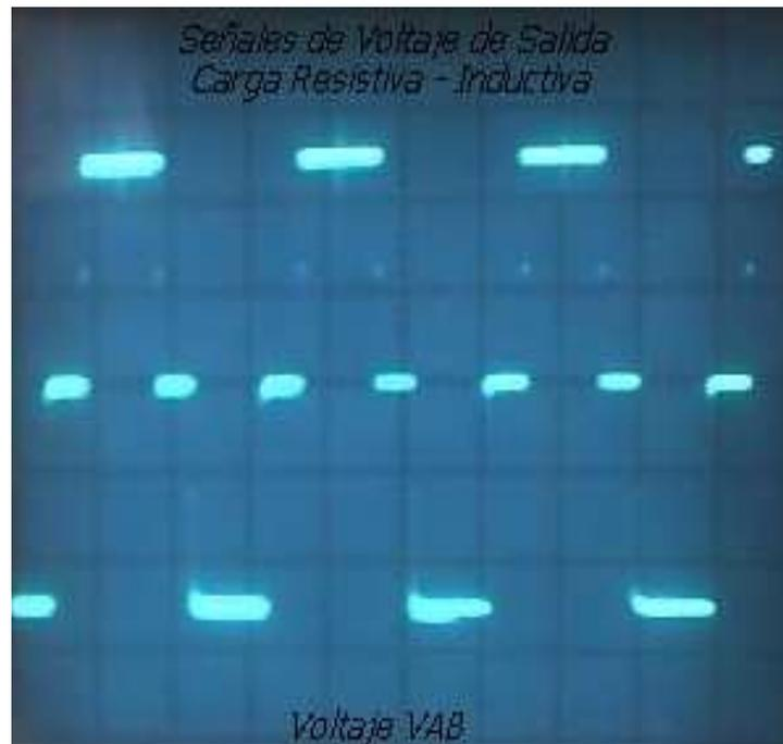
**FIG 6.18** Carga Resistiva - Inductiva Voltaje VAB
