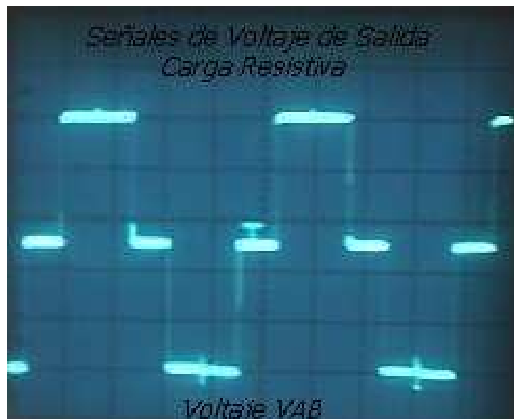
FIG 6.12 Carga Resistiva Voltaje VAB
