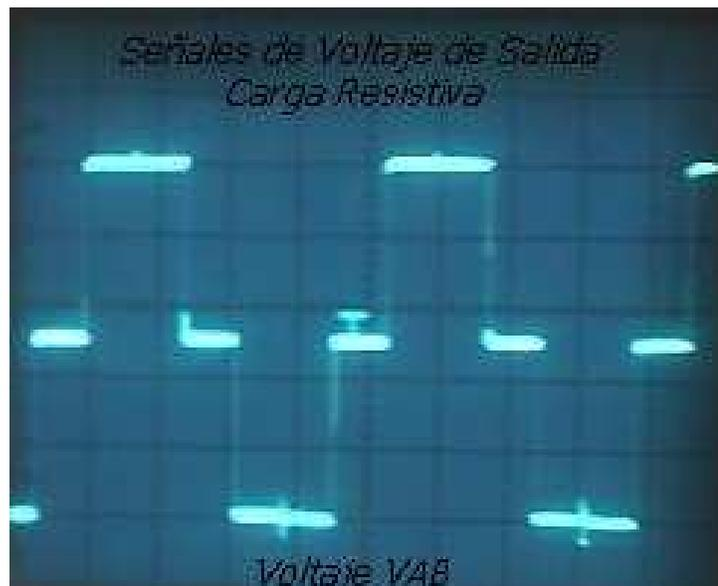
**FIG 6.12** Carga Resistiva Voltaje VAB
