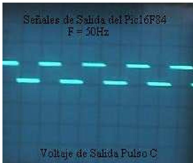
**FIG 6.5** Salida del Pic16 F84 Señal de Salida C
