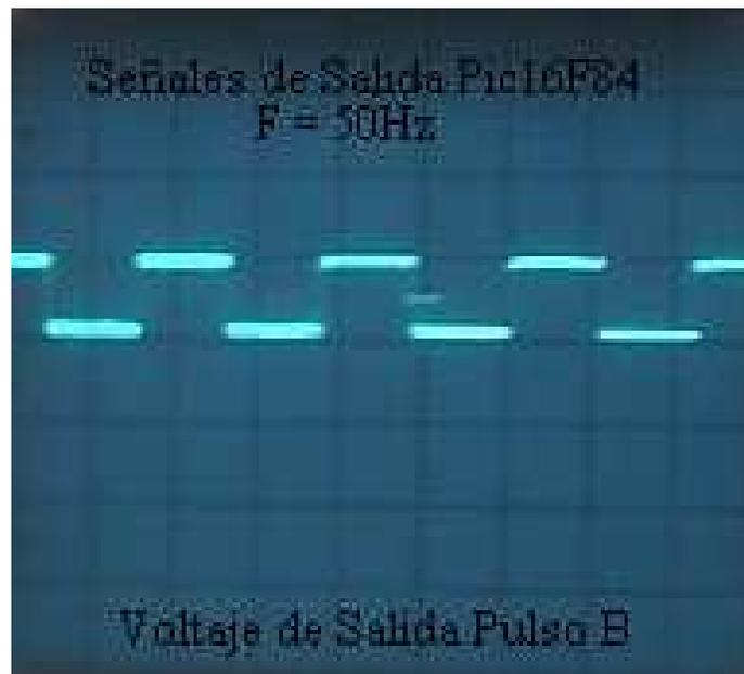
**FIG 6.4** Salida del Pic16 F84 Señal de Salida B
