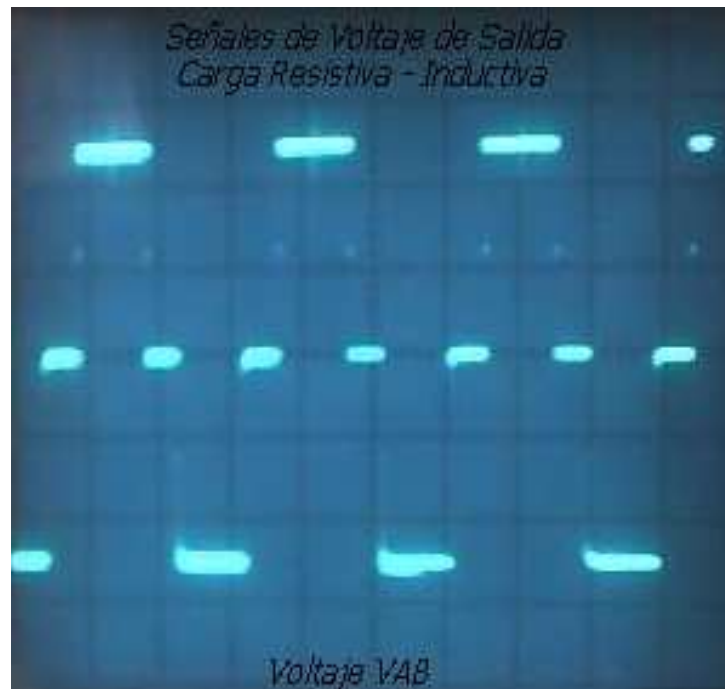
FIG 6.18 Carga Resistiva - Inductiva Voltaje VAB
