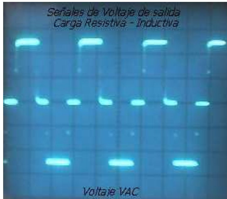
FIG 6.19 Carga Resistiva - Inductiva Voltaje VAC
