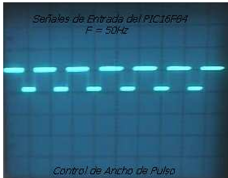
FIG. 6.1 Entrada al Pic16F84 Señal de Control de ancho de Pulso
