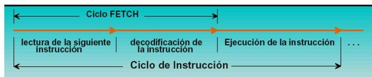
Figura 5-10. Ciclo de instrucción de un microcontrolador
