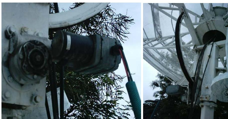
5. Revisamos posteriormente la estructura, si existen evidencias de oxidación sobre todo en las partes críticas como la cremallera o el reductor de velocidad procederemos a pintarlos nuevamente, la pintura que se debe utilizar es esmalte anticorrosivo color blanco.
