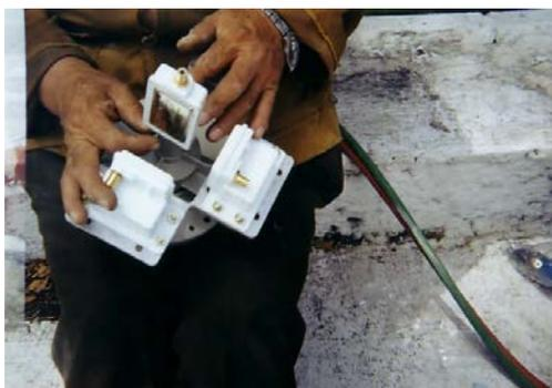
Figura 4-11 Instalación de los LNB en el alimentador de la antena parabólica.
