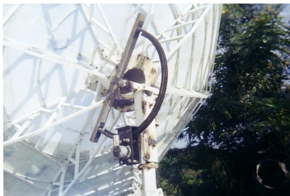
Figura 4-6 Colocación de la Cremallera y el reductor de velocidad para que la antena gire de  $0^{\circ}$  hasta  $180^{\circ}$
