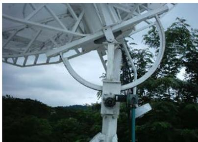
Figura 4-14 Sistema de posicionamiento completo
