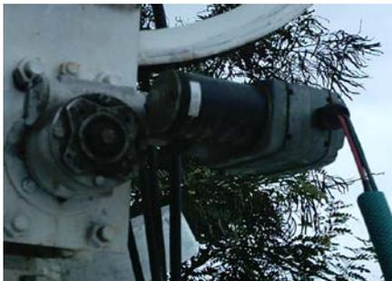
Figura 4-13 Motor de posicionamiento acoplado al reductor de velocidad.
