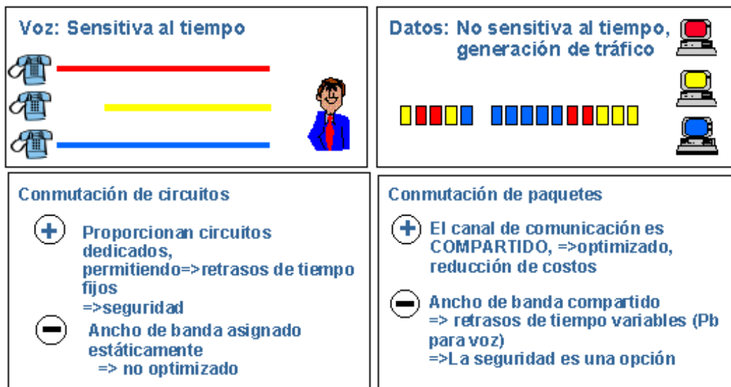
Figura 1.2 Diferencias entre la conmutación de circuitos y la conmutación de paquetes.
