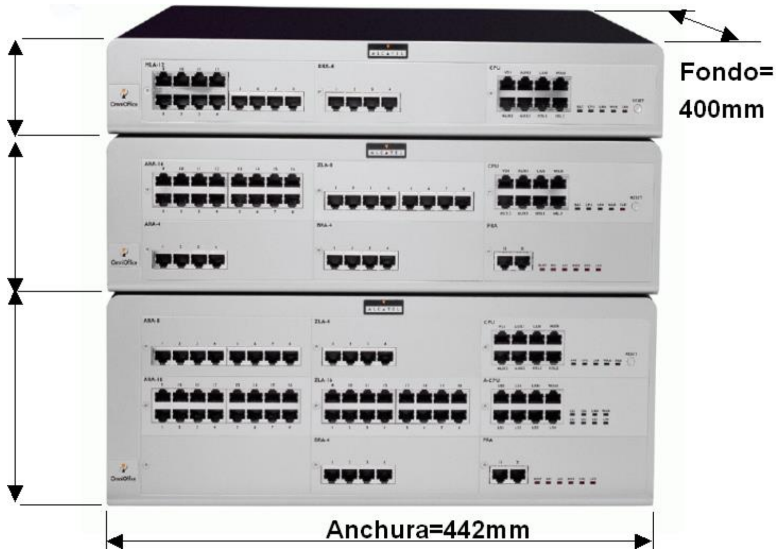
Figura 3.2 Servidor de Comunicaciones OmniPCX Office
