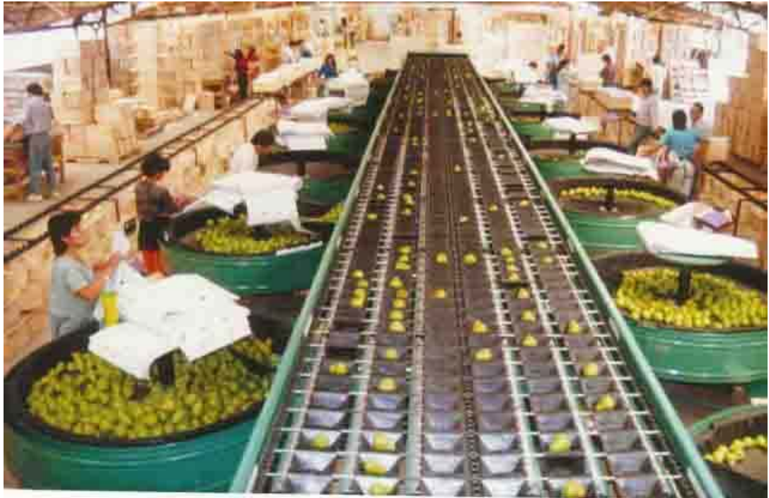
Figura 4.4 Calibrador electrónico para selección de fruta
