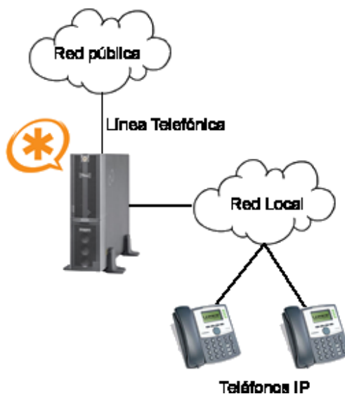
Figura 5.6: Estructura de comunicación entre Asterisk y la red pública
