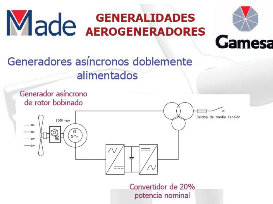
Figura 2.3 Generador asíncrono doblemente alimentado
