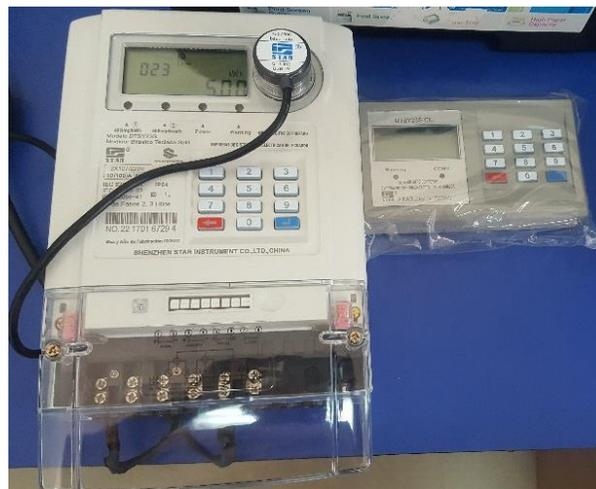
*Figura 12. Medidor Monofásico Bicuerpo.*
