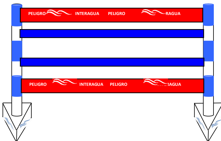
FIGURA 25: VALLAS DE CAÑA GUADUA (PLAN DE SEGURIDAD Y SALUD OCUPACIONAL DE INTERAGUA)
