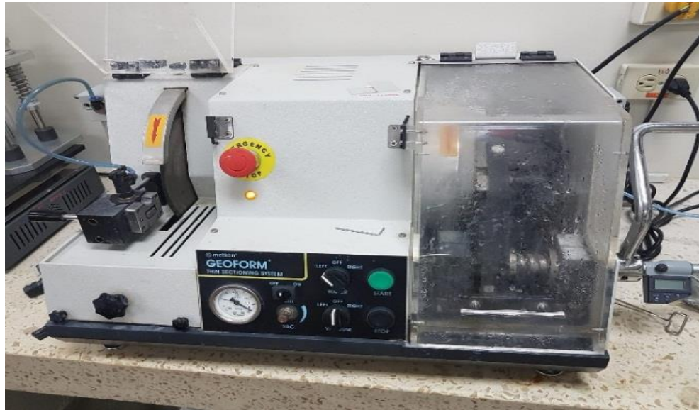
Figura 2.4 Equipo mecánico empleado para el corte y desbaste de la muestra.
