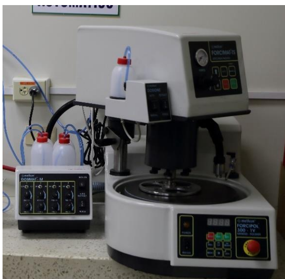
Figura 2.5 Equipo mecánico empleado para la etapa final del desbaste de la sección delgada.
