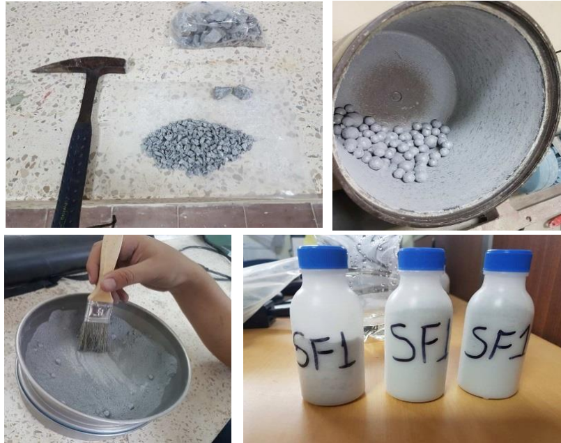
Figura . Proceso para la elaboración de muestras previo al análisis de difracción de rayos x.
