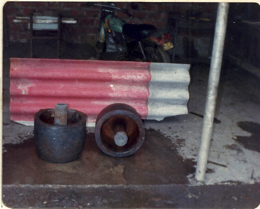
Foto. # 9. MOLDES DE OLLA SIN MAQUINAR
