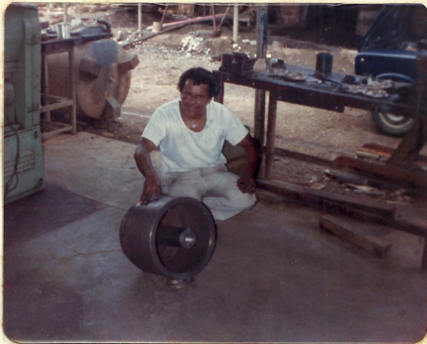
Foto # 13. MOLDE DE OLLA TERMINADO DE MAQUINAR.
