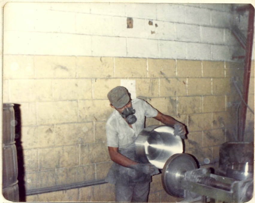
Foto # 3. OLLA DE ALUMINIO TERMINADA DE REPUJAR
