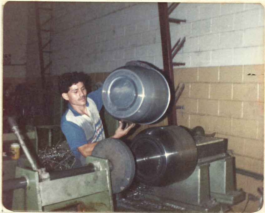
Foto # 3. OLLA DE ALUMINIO TERMINADA DE REPUJAR
