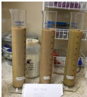
**Fig. 4.2.** Muestras sedimentando en probetas según Ley de Stokes.
