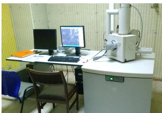
**Fig. 3.11.** Microscopio Electrónico de Barrido marca FEI Inspect S50.
