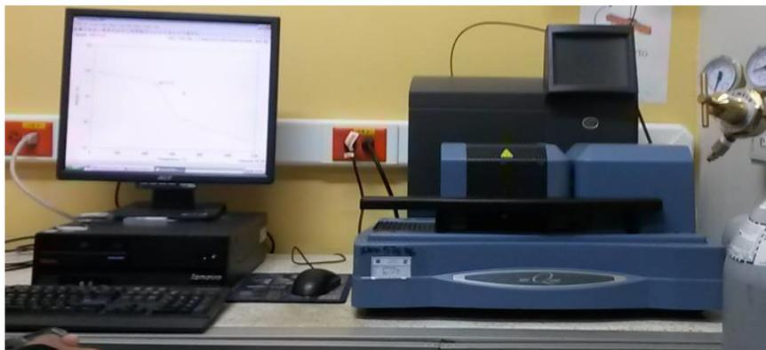
**Fig. 3.10.** Analizador termogravimétrico marca TA instruments Q600 SDT.
