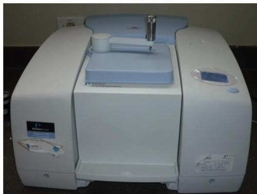
**Fig. 3.9.** Espectrómetro marca Perkin Elmer Spectrum 100 FTIR.
