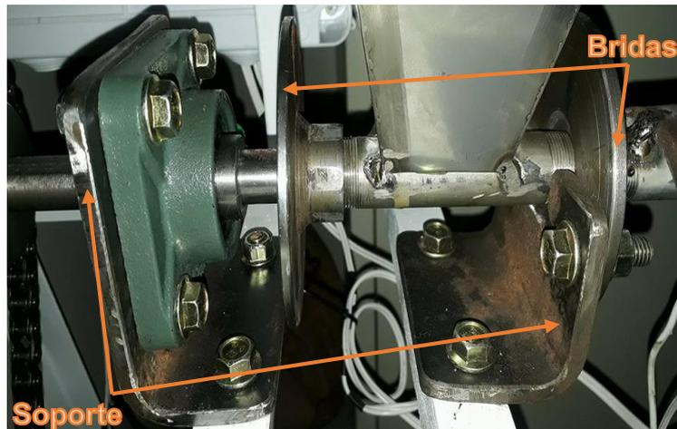
**Figura 3.3. Brida y base de la extrusora.**
