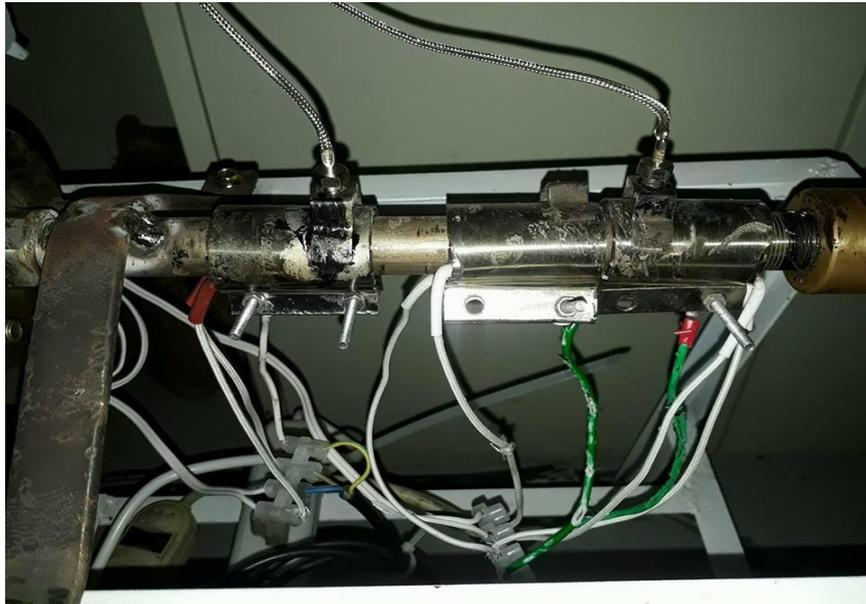
**Figura 3.11. Sistema de distribución de resistencias.**
