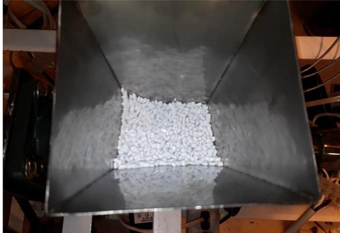
**Figura 3.5. Tolva alimentada con pellets.**
