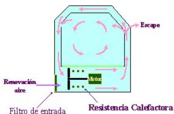
Figura 4.3 Distribución de calor en una termocuna.
