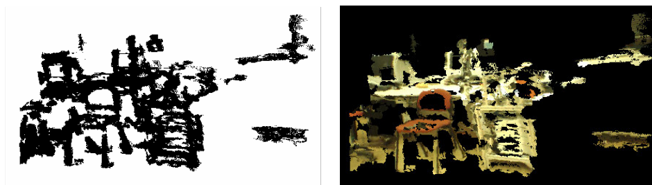
Figura 4.6.- (fila superior) Par de nubes de puntos consecutivas; (fila inferior) Nubes de puntos alineadas a partir de la matriz de transformación.
