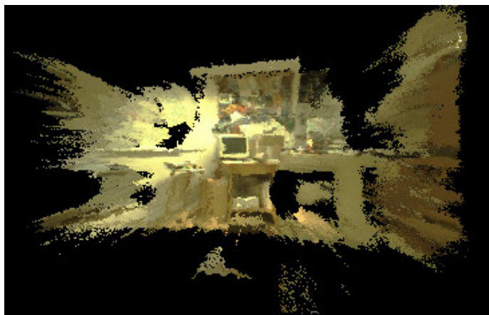
Figura 4.13.- Mapa 3D de ambiente de navegación del robot
