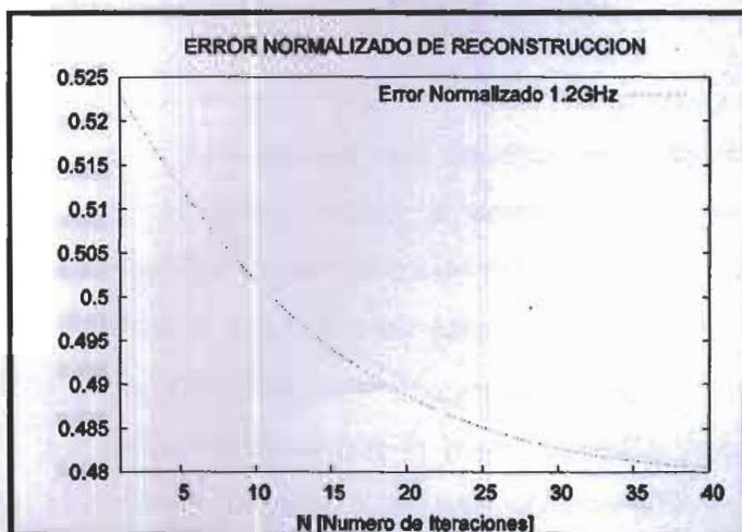
Figura 5.137: Error normalizado de reconstrucción al variar el número de iteraciones con  $f_H = 1.2GHz$
