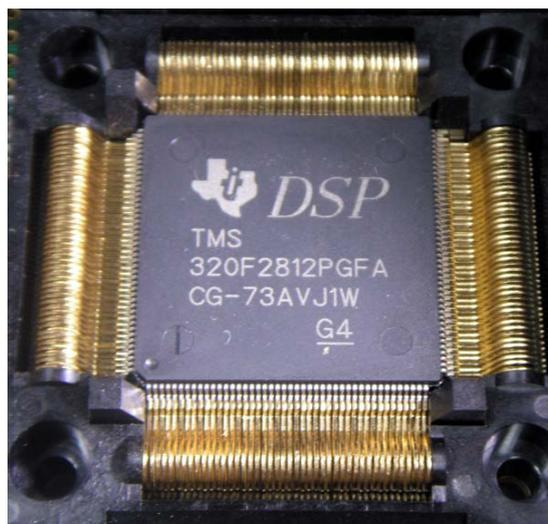
**Figura 4.2** Foto del DSP TMS320f2812
