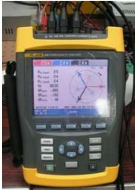
**Figura I.1** Analizador de energía trifásico FLUKE 435
