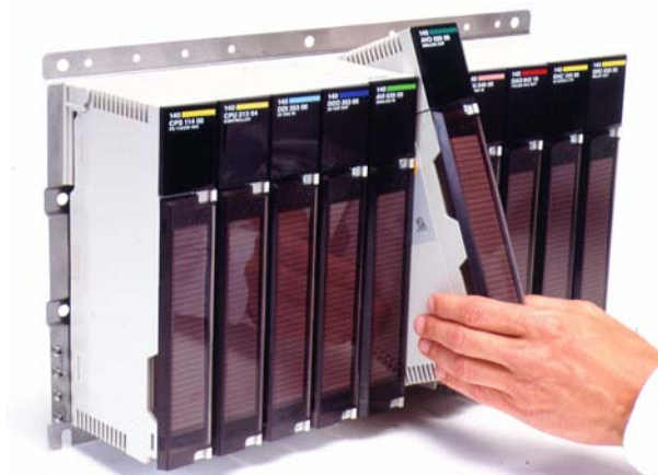
Figura 5.4 Módulos Quantum montados en Backplane
