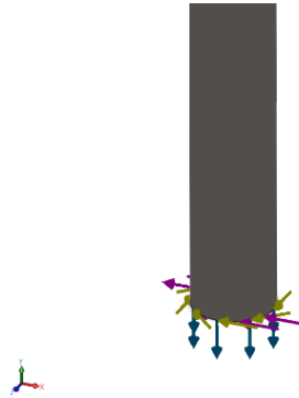
Figura 2.27 Cargas sobre el eje
