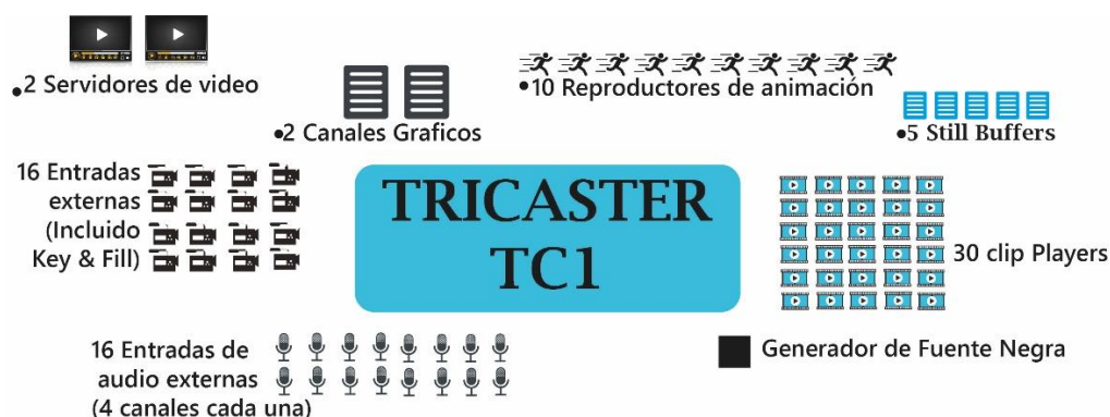
Figura 2.7: Funcionamiento del Tricaster TC1.
