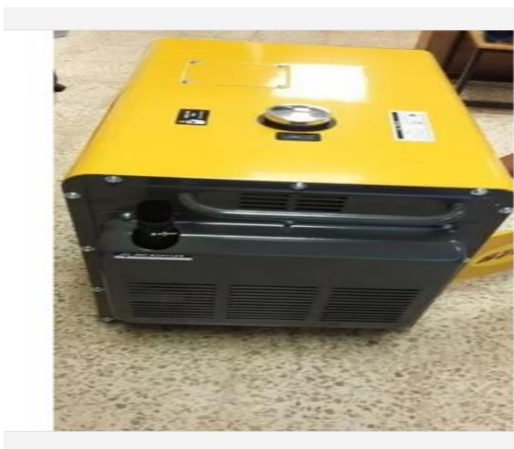
Figura 2.6: Generador a diésel de 7 Kva.
