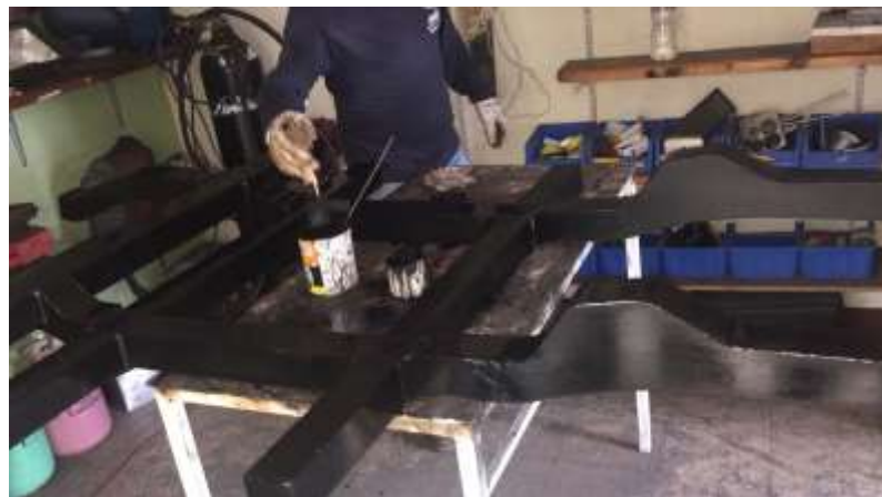
Figura 3.31 Capa de protección a la corrosión
