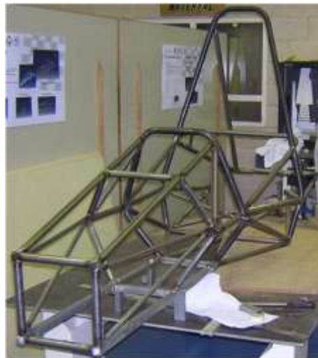
Figura 1.11 Chasis tubular de acero de un formula SAE
