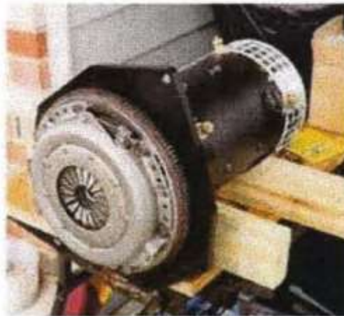
Figura 1.4 Motor eléctrico adaptado para ser instalado en un vehículo convencional
