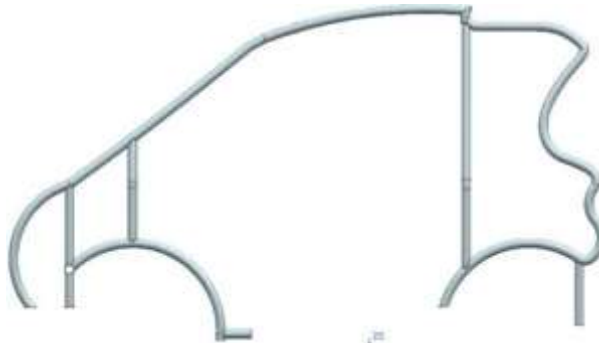
Figura 3.10 Soportes de la estructura tubular
