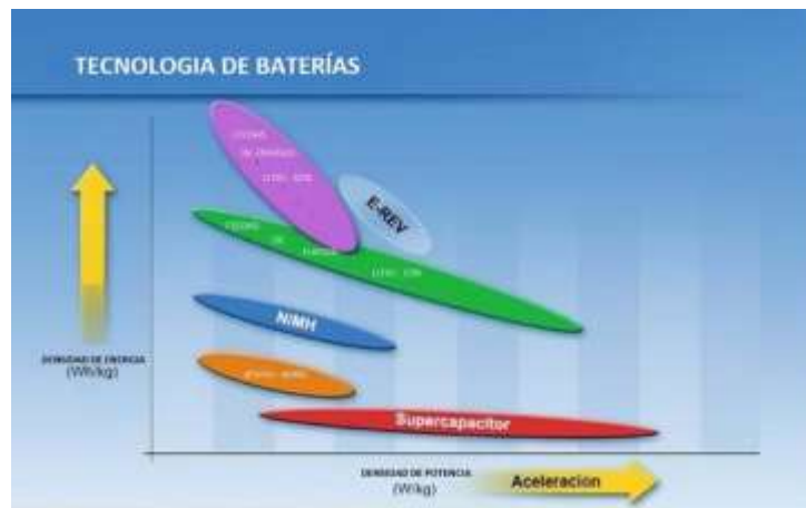
Figura 1.7 Curva de Densidad de energía vs densidad de poder de las baterías
