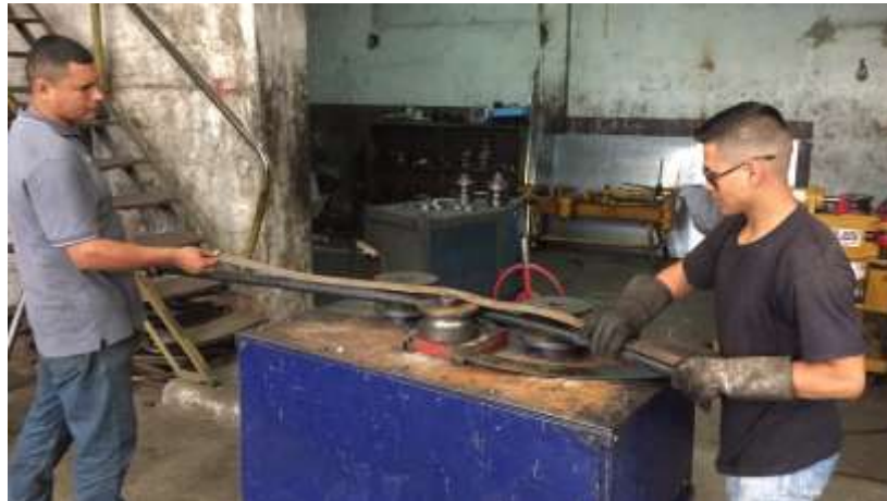
Figura 3.34 Proceso de rolado de tubos
