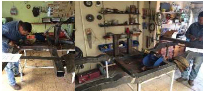
Figura 3.30 Proceso de Armado de la base de chasis
