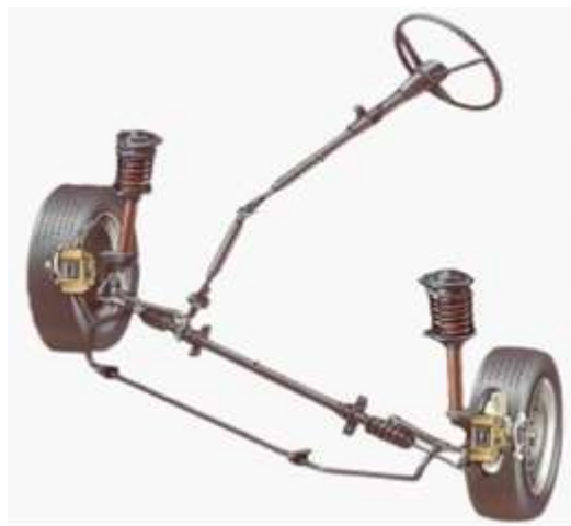
Figura 1.10 Sistema de dirección piño – cremallera
