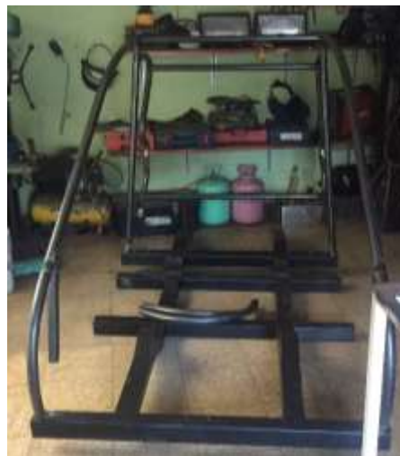
Figura 3.37 Ensamble final con puntos de soldadura
