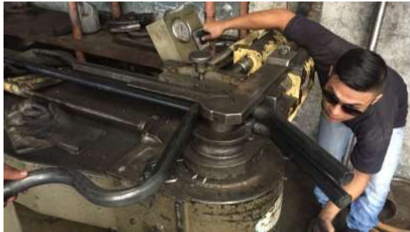
Figura 3.32 Proceso de doblado de tubos
