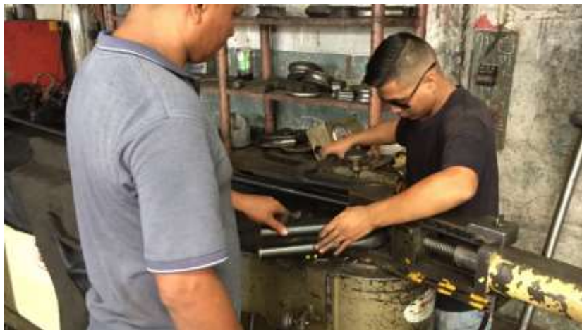
Figura 3.33 Proceso de doblado de tubos
