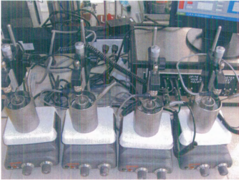
FIGURA 3.50 REALIZACIÓN DE LA PRUEBA DE HINCHAMIENTO LINEAL
