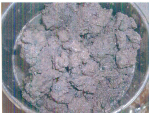
FIGURA 2.4. MUESTRA DE RIPIOS SIENDO LAVADA
