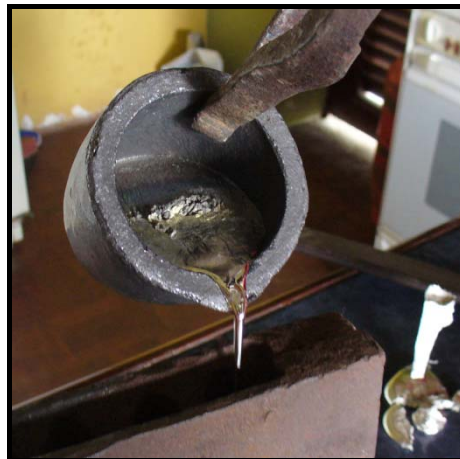
FIGURA 1.23 VACIANDO COLADA CON FLUJO LAMINAR EN MOLDE METALICO
