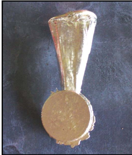
FIGURA 2.2 MEDALLON PARA ENSAYO DE LA METALOGRAFÍA Y DUREZA
