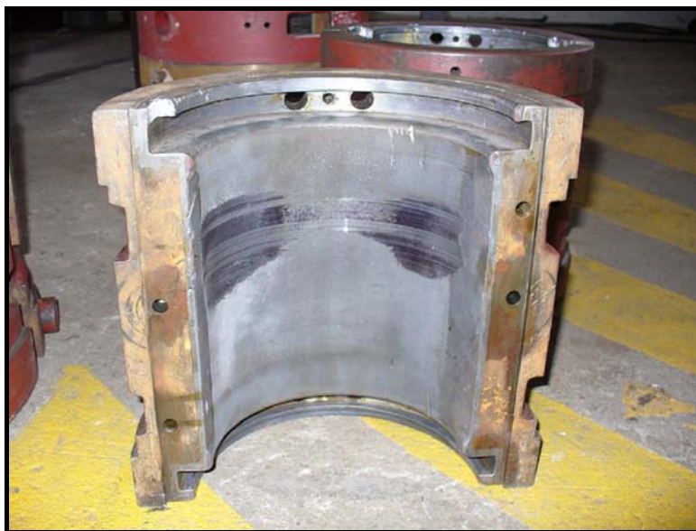
FIGURA 1.7 CONDICIÓN SUPERFICIAL DE COJINETES DE TURBINA PELTON
