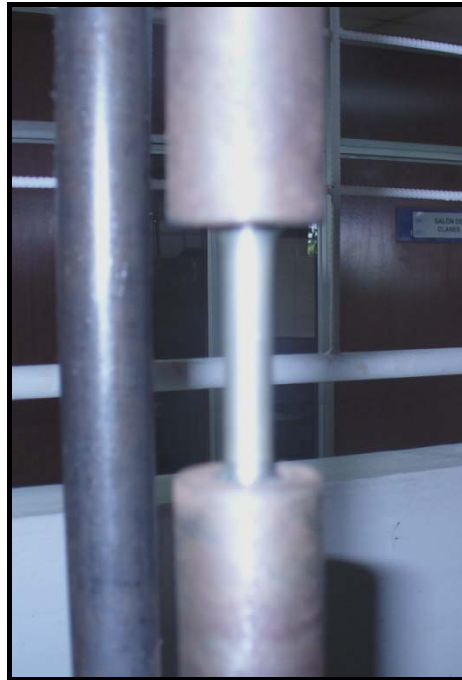
FIGURA 2.12 PROBETA DE BABBITT 13 EN BASE DE PB SOMETIDA AL ENSAYO DE TRACCIÓN
