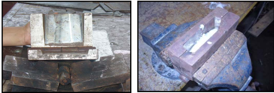
FIGURA 1.22 MOLDE METALICO PARA CUÑA DE TEMPLE
