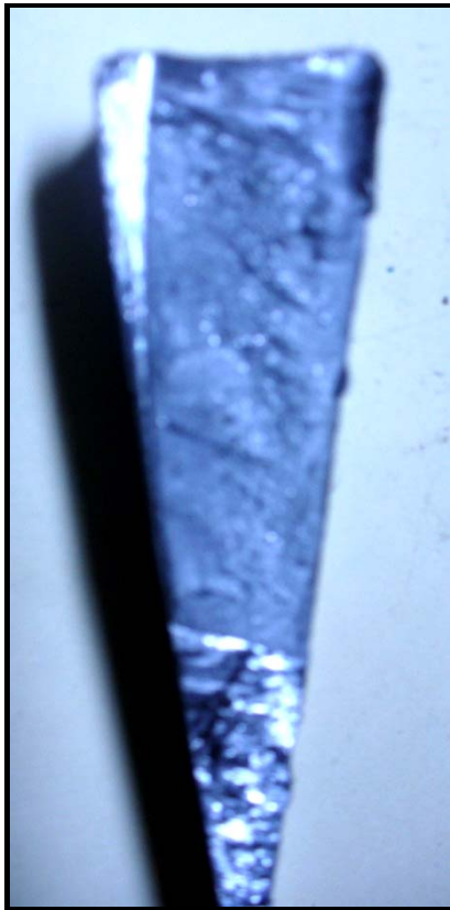
FIGURA 2.9 FRACTURA DE CUÑA EN BASE DE Sn
