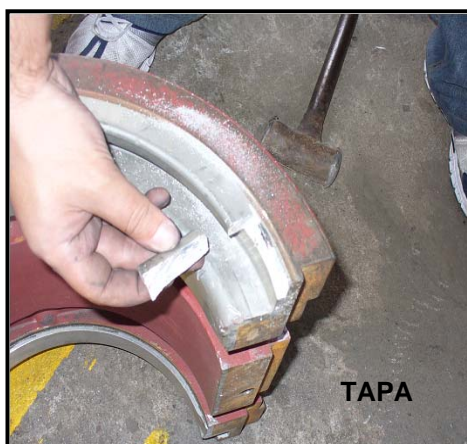
FIGURA 1.8 TOMA DE MUESTRAS DEL LOS COJINETES
