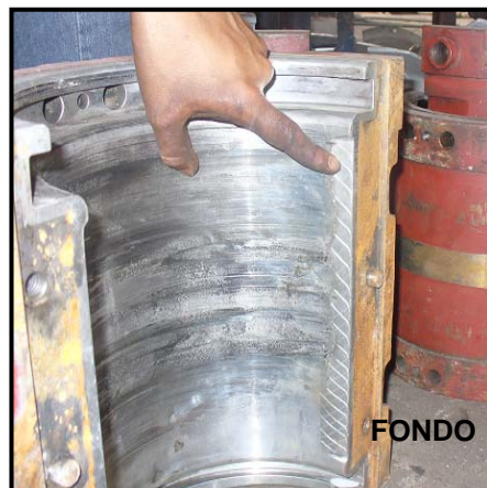
FIGURA 1.8 TOMA DE MUESTRAS DEL LOS COJINETES
