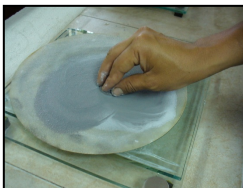
FIGURA 1.11 MESA DE PULIDO PARA PASTA DE DIAMANTE
