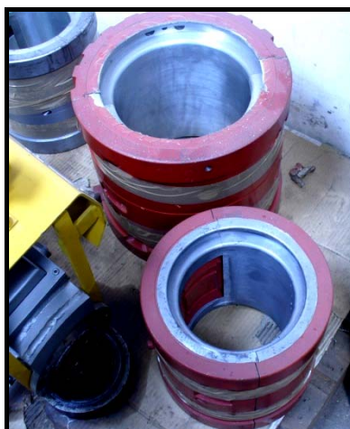
FIGURA 3.6 COJINETES LISTOS PARA EL USO EN LA TURBINA PELTON
