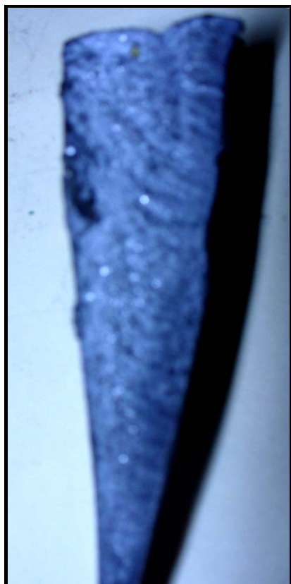
FIGURA 2.14 FRACTURA DE CUÑA EN BASE DE PLOMO
