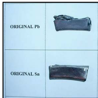
FIGURA 1.13 PROBETAS DE BABBITTS ORIGINALES, PREPARADAS PARA SER OBSERVADAS AL MICROSCOPIO LEITZ
