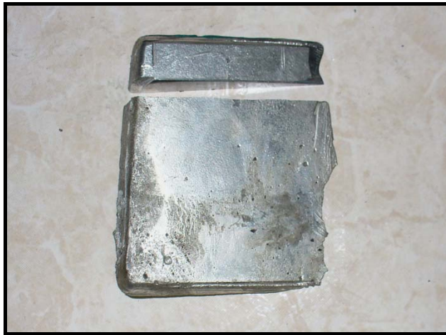
FIGURA 1.24 CUÑA DE TEMPLE DE METAL BABBITT 3 ORIGINAL Y OBTENCIÓN DE PROBETA
