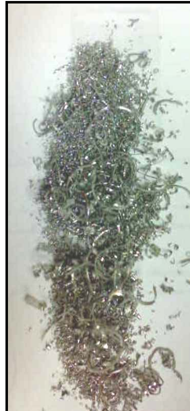
FIGURA 2.10 BABBITT EN BASE Sn Y SU TIPO DE VIRUTA
