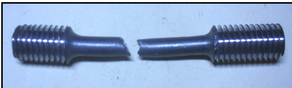
FIGURA 2.13 FRACTURA LEVEMENTE FRÁGIL DE PROBETA EN BASE DE PLOMO
