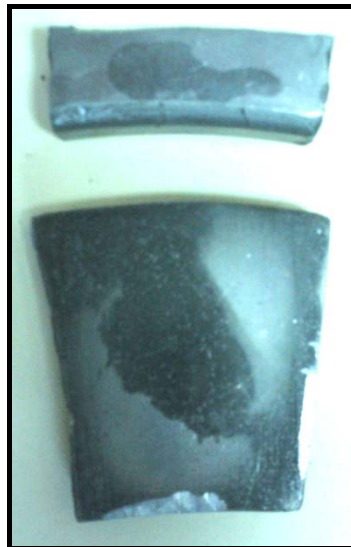
FIGURA 3.2 PROBETAS DE COJINETES METALIZADOS ATACADAS CON 2% DE NITAL
