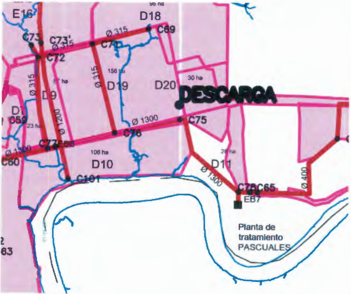
Figura 3.26 Punto de descarga de la zona de estudio y pozo C75 del colector matriz proyectado de Interagua.
