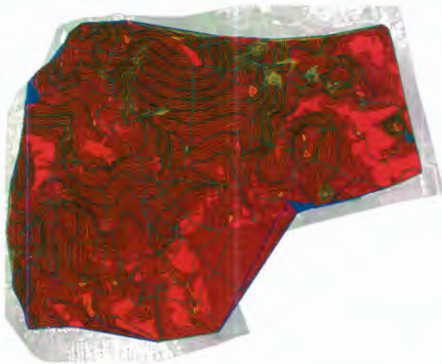
Figura 3.12 Pendientes del terreno de la zona de estudio
