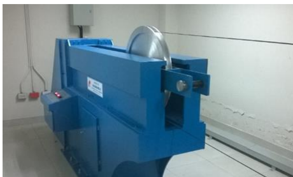
Figura 1.1 Plataforma para prueba de tensión de cable de fibra óptica
