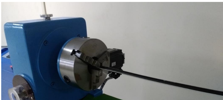
Figura 3.2 Cable de ducto alineado en el equipo de torsión.
