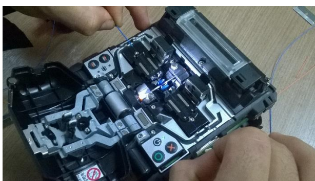
Figura 3.10 Fusión de la fibra
