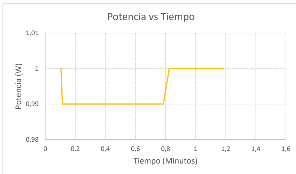
Figura 3.14 Potencia medida de la fibra naranja
