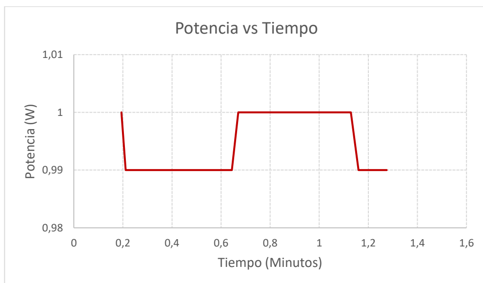
Figura 3.19 Potencia medida de la fibra rojo
