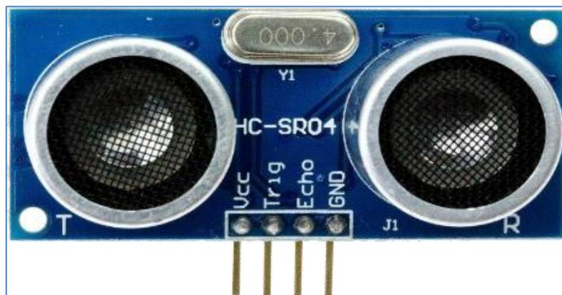
Figura 3.1 Sensor de ultrasonido HC-SR04
