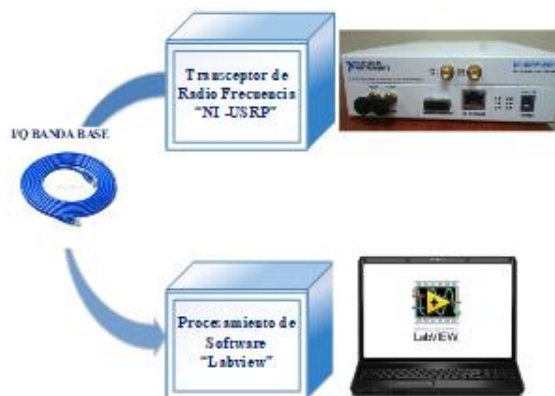
Figura 2.13: Descripción de una configuración de radio definido por software
