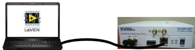
Figura 2.15: Conexión física entre el host y el equipo NIUSRP 2921
