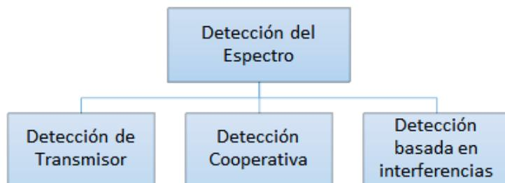
Figura 2.6 Clasificación de las técnicas de detección del espectro [21]
