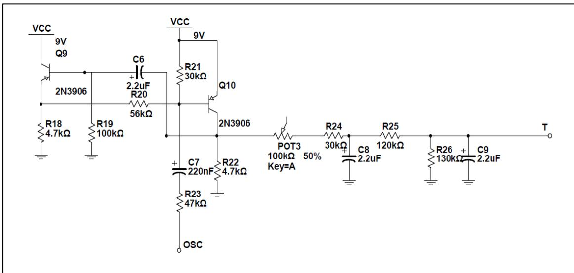
Fig. 2.6. Diagrama generador de la onda T
