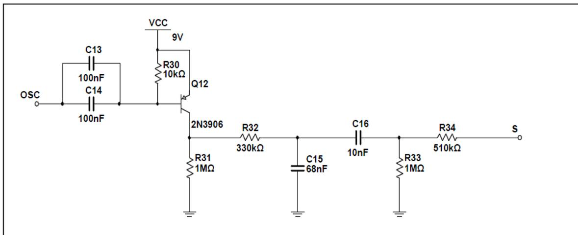
Fig. 2.5. Diagrama generador de la onda S
