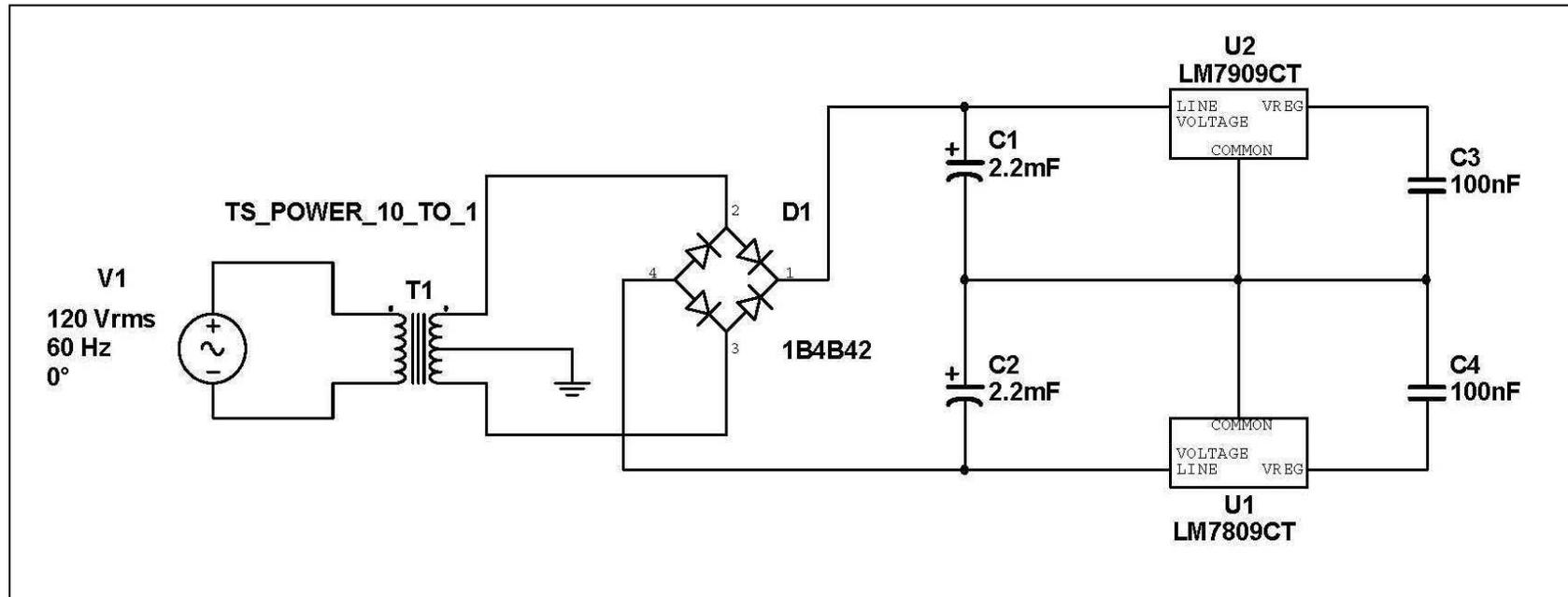
Anexo A. Diagrama esquemático del regulador utilizado en la alimentación del simulador cardíaco
