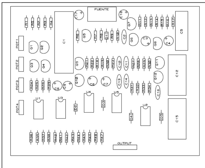
Fig. 3.4. Ubicación de los elementos en la placa
