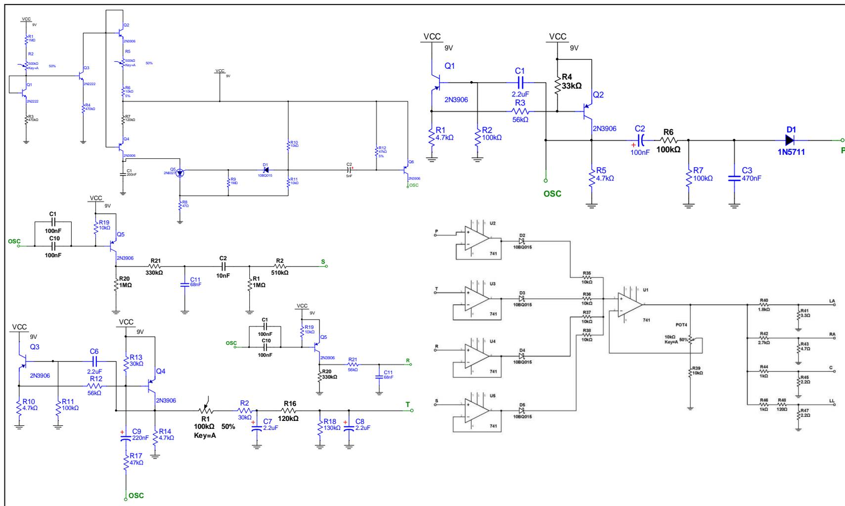
Fig. 3.1. Diagrama esquemático funcional del simulador cardíaco
