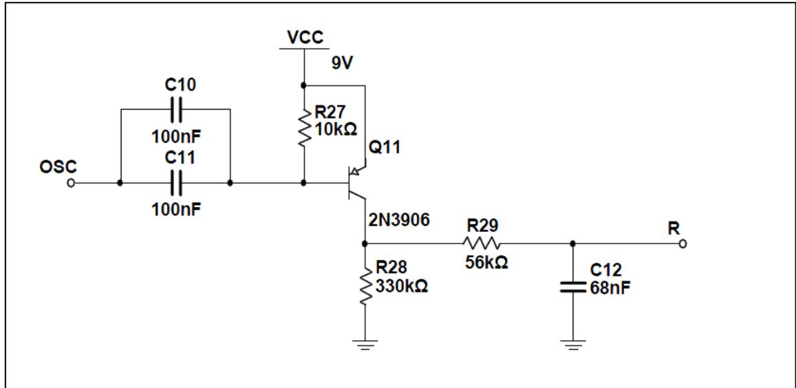
Fig. 2.4. Diagrama generador de la onda R
