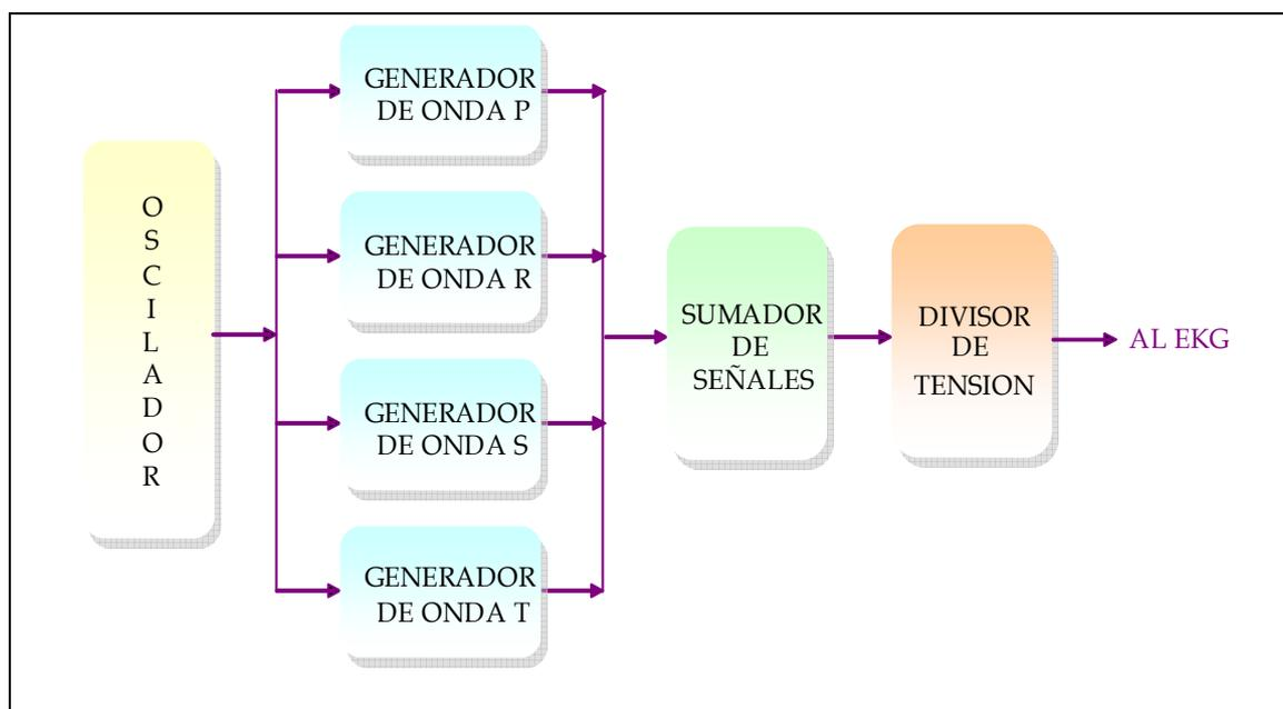
Fig. 2.1. Diagrama de bloques funcional del simulador cardíaco
