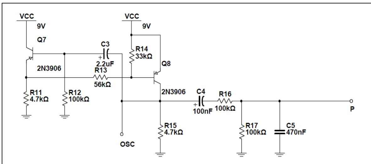
Fig. 2.3. Diagrama generador de la onda P
