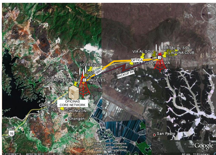
Figura 3.13 Conexiones entre Nodos B y Core Network. 42
