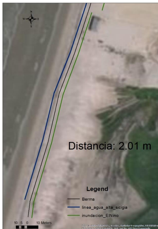
Ilustración 28. Alcance debido el evento El Niño condiciones de pleamar en sicgia. Distancia entre Berma y línea de Inundación. Zona 1.
