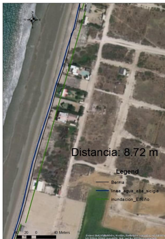
Ilustración 36. Alcance debido al evento El Niño en condiciones de pleamar en sicigia. Distancia entre Berma y línea de Inundación. Zona 2.
