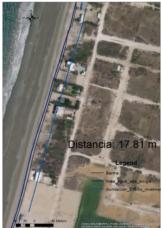
Ilustración 37. Alcance debido a el evento El Niño y aumento del nivel del mar en condiciones de pleamar en sicigia. Distancia entre Berma y línea de Inundación. Zona 2.
