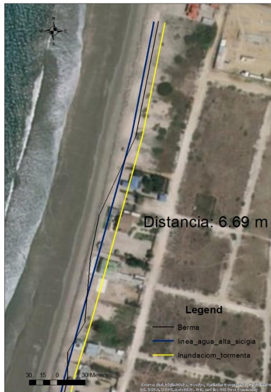
Ilustración 41 Alcance debido a oleaje de tormenta en condiciones de pleamar en sicigia. Distancia entre Berma y línea de Inundación. Zona 3.
