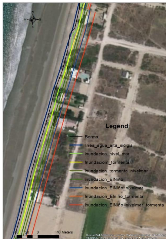
Ilustración 40. Alcance en los diversos escenarios, en condiciones de pleamar en sicigia. Distancia entre Berma y línea de Inundación. Zona 2.
