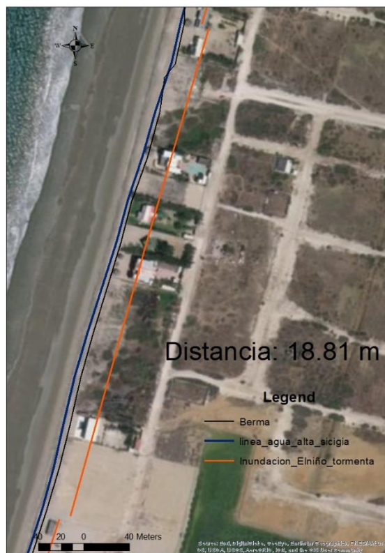
Ilustración 38. Alcance debido al evento El Niño y oleaje de tormenta en condiciones de pleamar en sicigia. Distancia entre Berma y línea de Inundación. Zona 2
