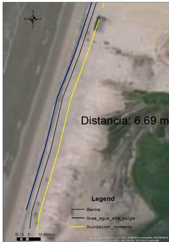
Ilustración 25. Alcance debido a oleaje de tormenta en condiciones de pleamar en sicigia. Distancia entre Berma y línea de Inundación. Zona 1.
