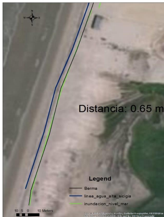
Ilustración 26. Alcance debido el aumento del nivel del mar en condiciones de pleamar en sicigia. Distancia entre Berma y línea de Inundación. Zona 1.
