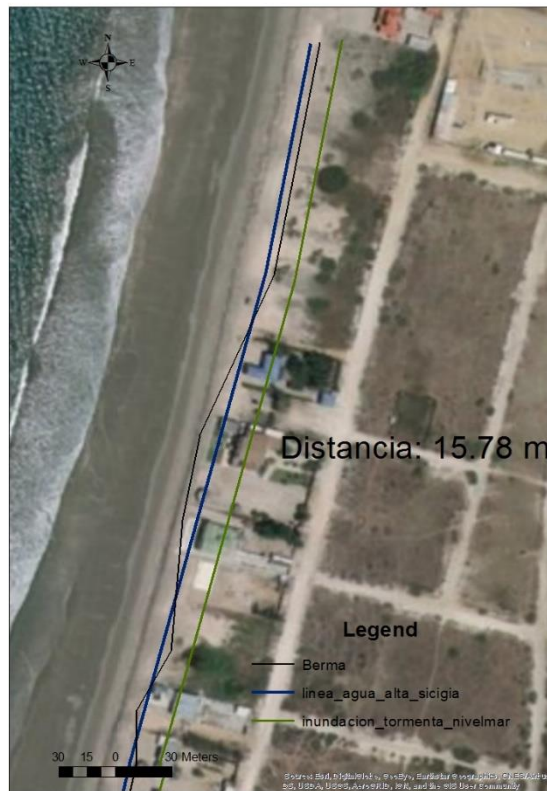
Ilustración 43. Alcance debido al aumento del nivel del mar y oleaje de tormenta en condiciones de pleamar en sicigia. Distancia entre Berma y línea de Inundación. Zona 3.
