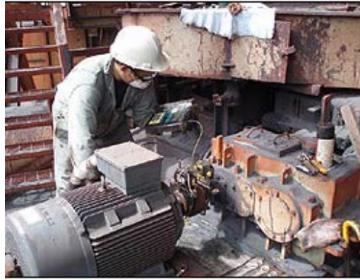
Figura 1.6: Aplicación del Acelerómetro en el Análisis de Vibraciones
